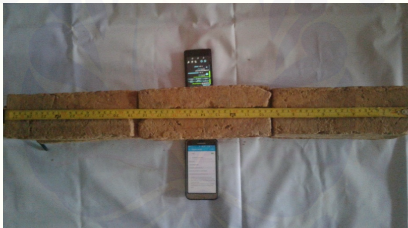
Pengukuran intensitas pada tembok (batu bata) ketebalan 8 cm
