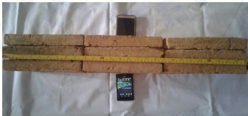
Pengukuran intensitas pada tembok (batu bata) ketebalan 12 cm
