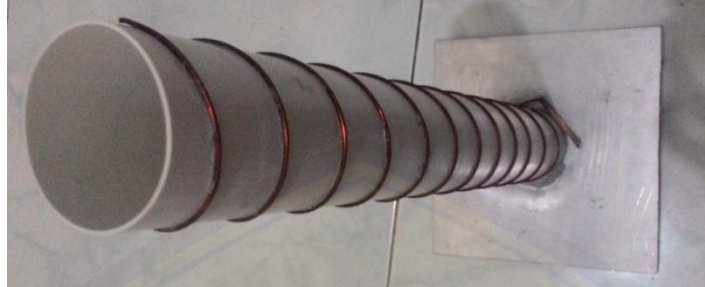
Gambar 1. Antena Helix Mode Axial Tampak Depan
