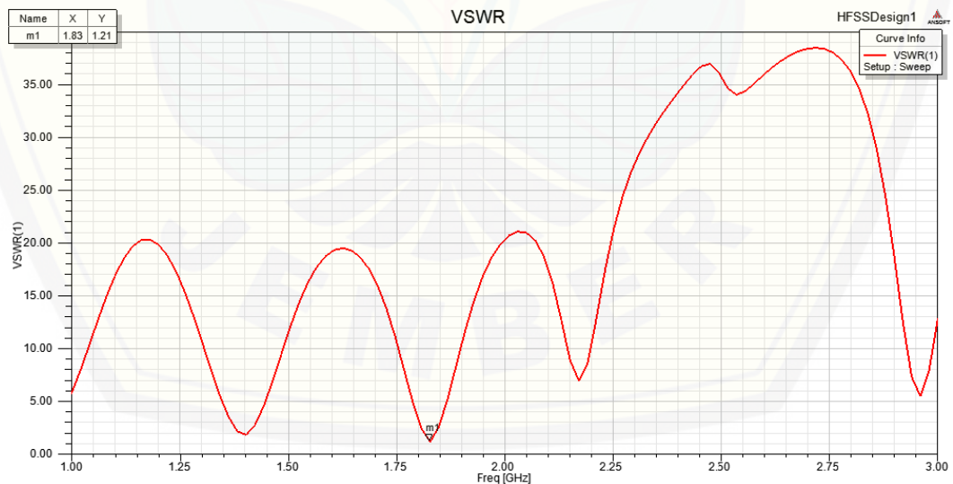
Gambar 3.26 Grafik VSWR Antena Patch Meanderline Menggunakan DGS Setelah Proses Iterasi
