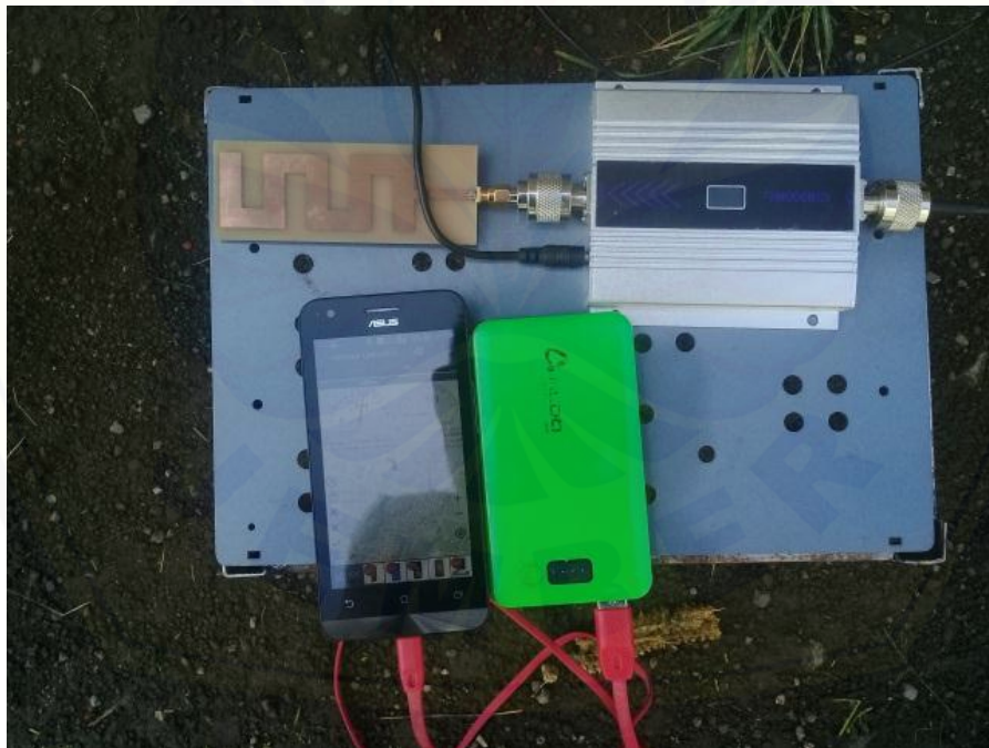
Gambar 12. Proses Integrasi Antena ke Repeater GSM
