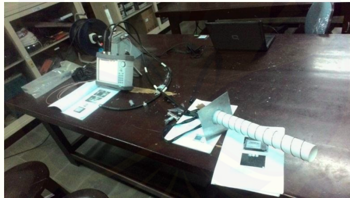
Gambar 7. Proses Pengujian VSWR dan Return Loss Antena Helix Mode Axial
