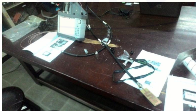
Gambar 8. Proses Pengujian VSWR dan Return Loss Antena Patch Meanderline DGS
