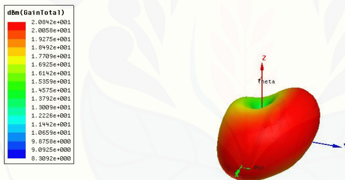
Gambar 3.28 Gain 3D Antena Patch Meanderline Menggunakan DGS Setelah Proses Iterasi
