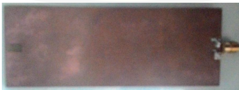
Gambar 4. Antena Patch Meanderline DGS Tampak Bawah
