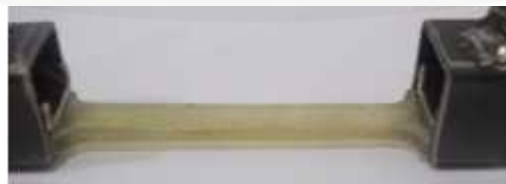
Gambar 3. Spesimen saat persiapan sebelum pengujian tarik
