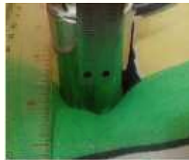
Gambar 1. Bantal diberi beban dan diukur perubahan tinggi bantal menggunakan jangka sorong
