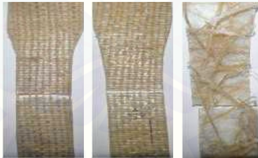
Gambar 2. Gambar patahan setelah anyaman dilakukan percobaan uji tarik
