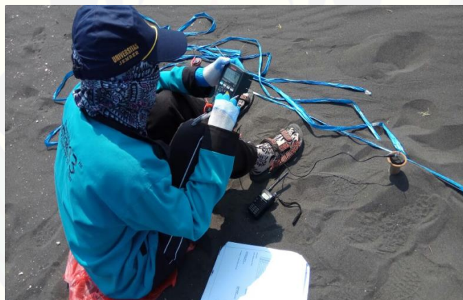
Gambar B.2 Pengukuran potensial pada elektroda base
