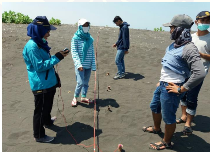
Gambar B.3 Pengukuran potensial pada elektroda rover pada pengambilan data 1
