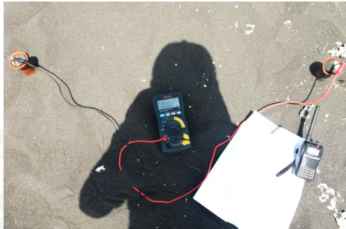
Gambar B.1 Pengukuran potensial menggunakan multimeter
