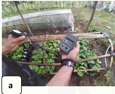
Pengukuran intensitas cahaya (a); pengukuran suhu (b); pengukuran kelembaban relatif (c)
