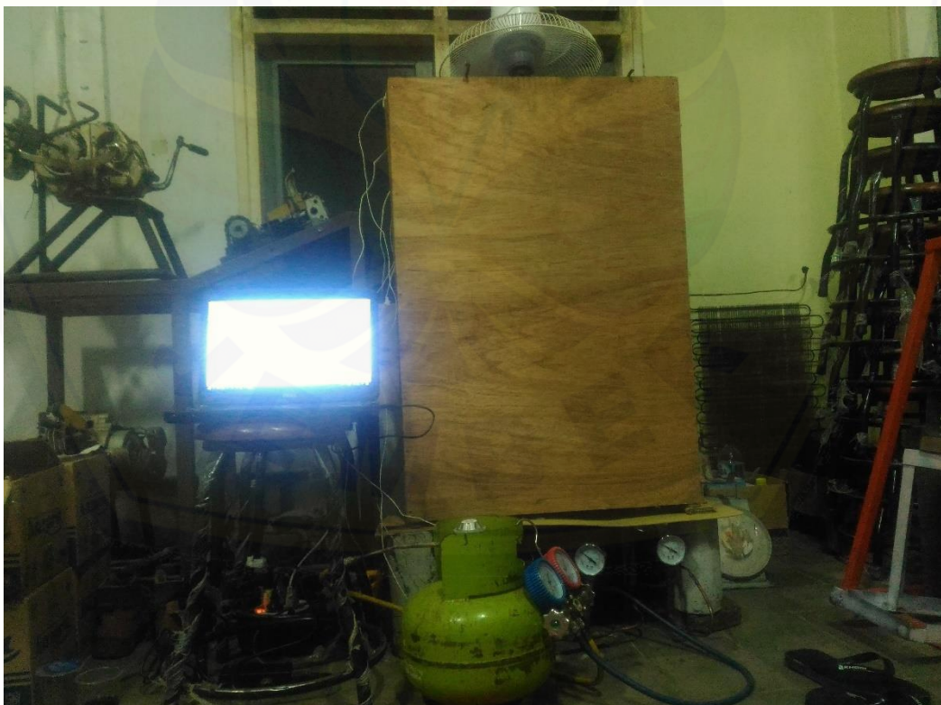
Gambar K.12 Pengujian separation condenser dengan penambahan subcooler
