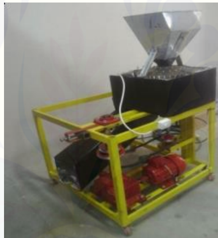
Gambar 2.1 Mesin pengupas kulit luar kacang tanah tipe ruji vertikal (Sumber : Danang,2015)
