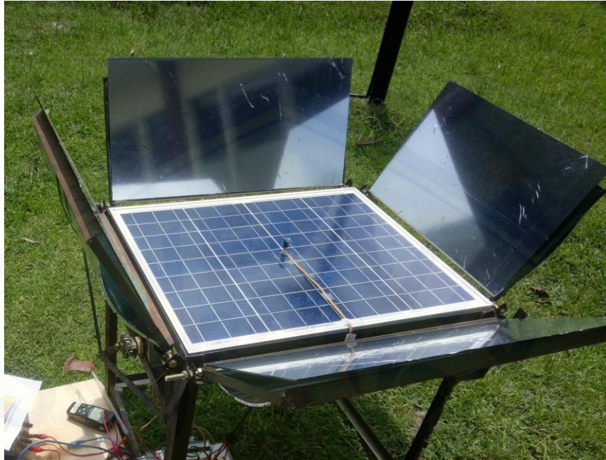
Gambar C.4 Pengujian Alat Menggunakan Reflektor Cermin Datar
