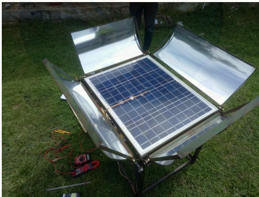
Gambar C.3 Pengujian Alat Menggunakan Reflektor Cermin Cekung
