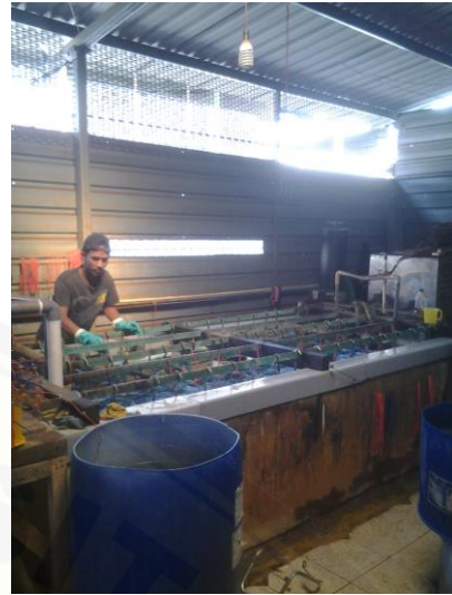
Gambar 6. Melapisi bahan baku dengan Nikel selama 20 menit
