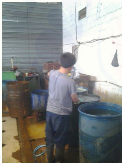
Gambar 7. Melapisi bahan baku dengan Kromium dan membilasnya dengan air
