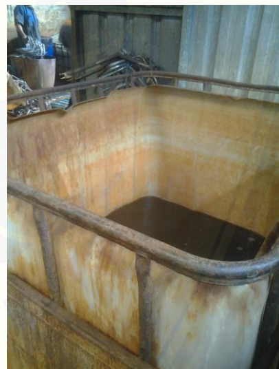
Gambar 4. Kemudian masukkan kedalam larutan soda api
