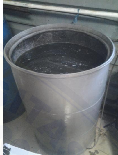
Gambar 2. Bahan Baku dimasukkan ke dalam larutan HCL
