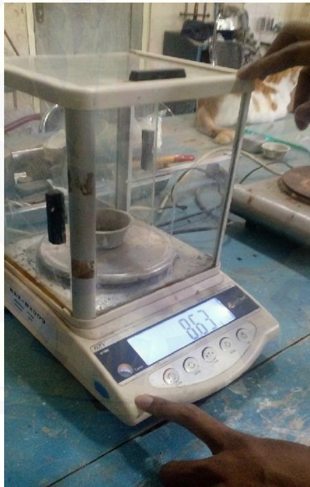
Lampiran 1.4 Gambar Pengujian Kadar Air
