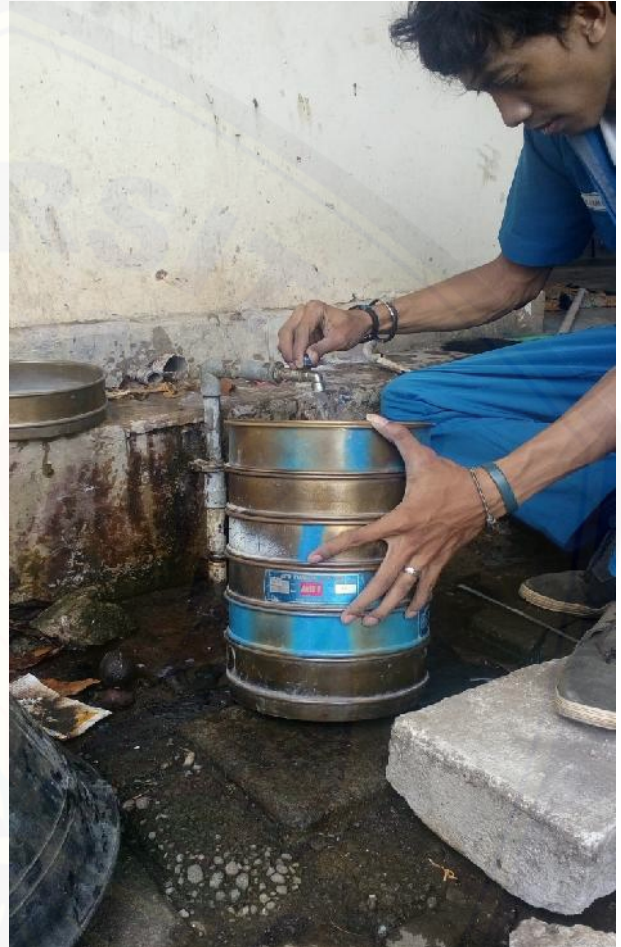
Lampiran 1.8 Gambar Pengujian Analisis Saringan Basah
