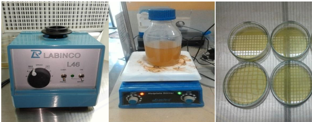
Gambar I.3 Hasil pengenceran konsentrasi kemudian dihomogenkan dengan mixing vortex . Kemudian mencampurkan akuades dan MHA dengan perbandingan 38/1000 mL. Kemudian dihomogenkan dengan menggunakan hot plate magnetic stirrer . Setelah media homogen dan dingin, masukkan media ke petridish yang sebelumnya sudah dilabeli menurut perlakuan.
