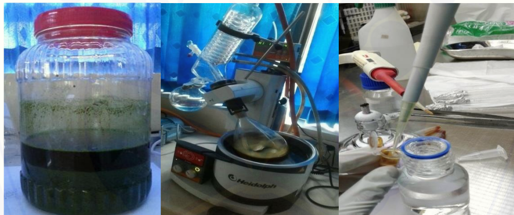
Gambar I.2 Serbuk dimasukkan toples dan dicampur dengan ethanol 96% sebanyak 1500 mL. Setelah itu, rendaman diaduk menggunakan spatula dan ditutup rapat. Rendaman didiamkan selama 24 jam, kemudian di shaker di atas shaker digital rpm 50. Ampas dan filtrat dipisah menggunakan kertas saring dan ditampung dengan erlenmeyer (lakukan remaserasi dengan ethanol 96% seperti di atas). Hasil ekstrak diuapkan dengan rotary evaporator selama 3 jam dan akhirnya proses ekstraksi selesai dilanjutkan dengan pengenceran konsentrasi ekstrak dengan akuades steril.
