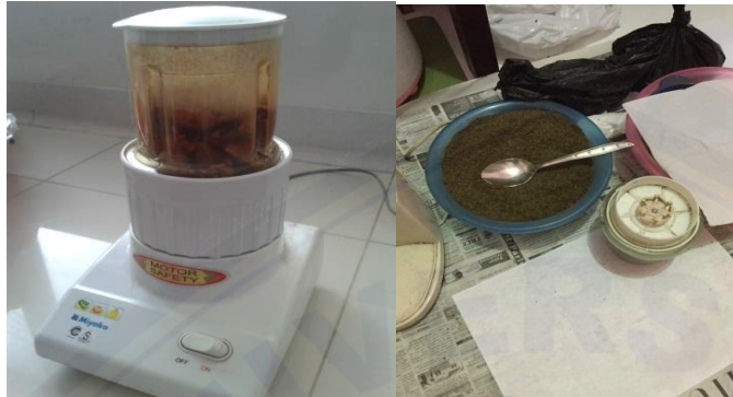
Gambar I.1 Daun kopi robusta kering, dipotong kecil lalu diblender kemudian disaring untuk diambil serbuk halusnya. Setelah itu serbuk ditimbang sebanyak 800 gr.
