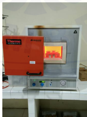
Gambar 3.2 Proses pengeringan ampas tebu dengan furnace (Sumber : Koleksi Pribadi)
