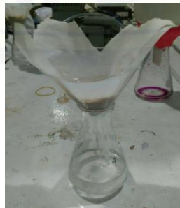
Gambar 3.5 Penyaringan campuran abu ampas tebu dengan larutan HCl menggunakan kertas saring (Sumber : Koleksi Pribadi)
