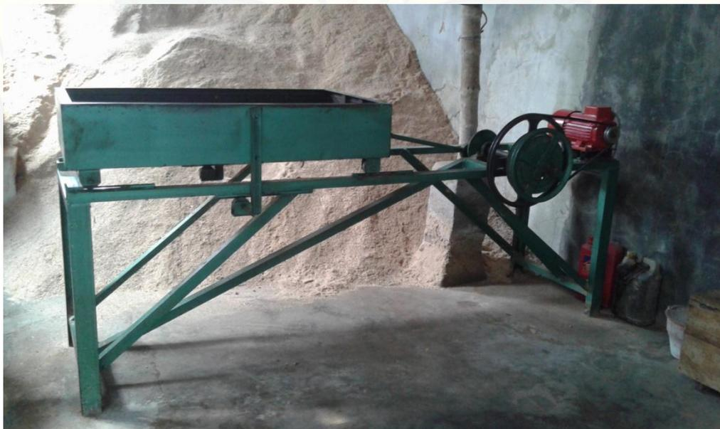
**Gambar 2. Mesin Ayak Produksi Baglog**
