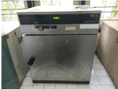
Gambar 3.5 Oven yang memanaskan botol timbang
