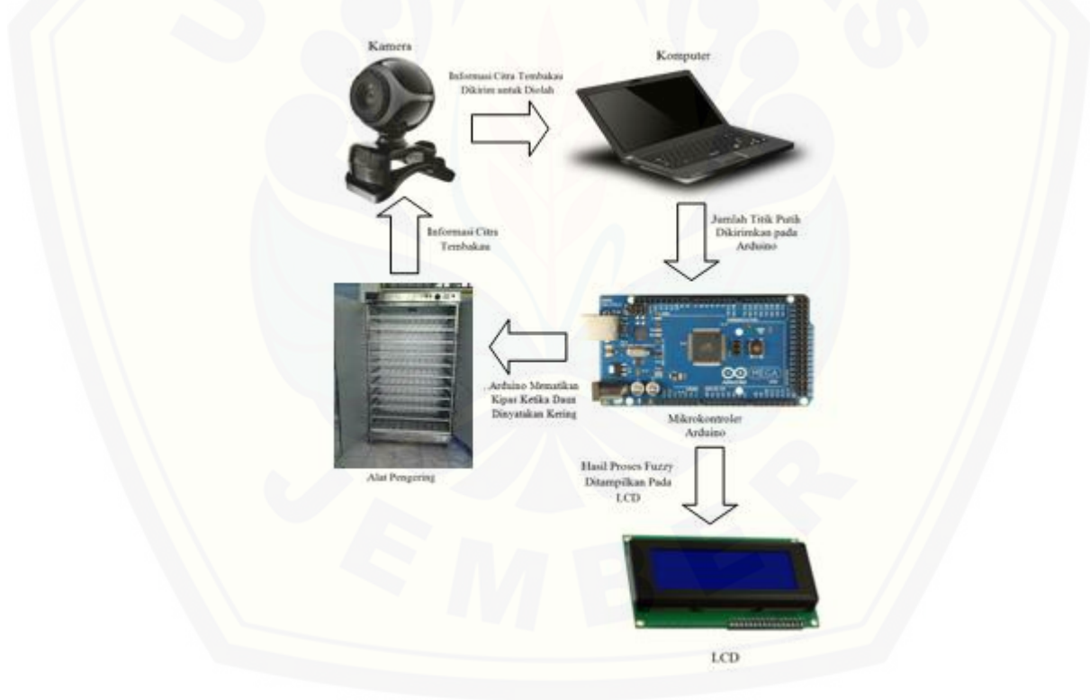
Gambar 3.1 Cara kerja alat pengering tembakau otomatis
