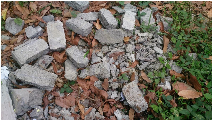
Lampiran 4.58 Bentuk Retakan Paving Block Keseluruhan Setelah Uji Kuat Tekan
