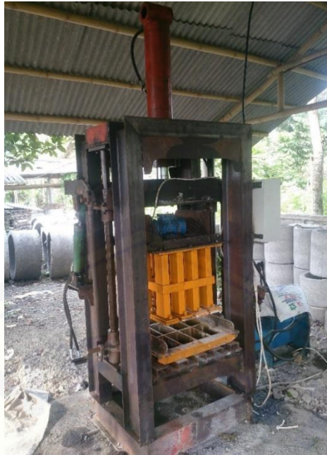
Gambar 3.6 Mesin Press kombinasi hidrolik dan vibrasi
