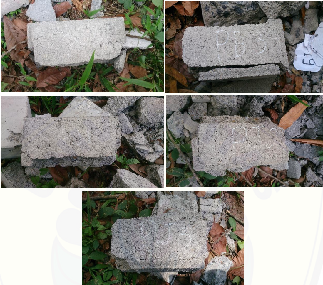
Lampiran 4.57 Bentuk Retakan Masing-masing Setelah Uji Tekan
