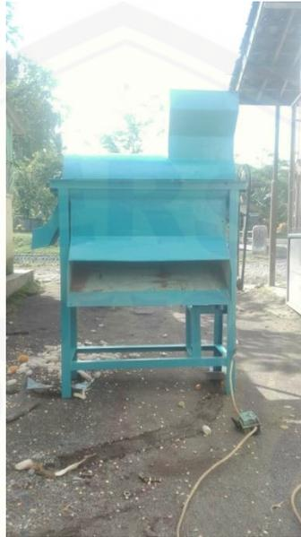
Gambar C.1 Mesin pemipil jagung tampak depan
