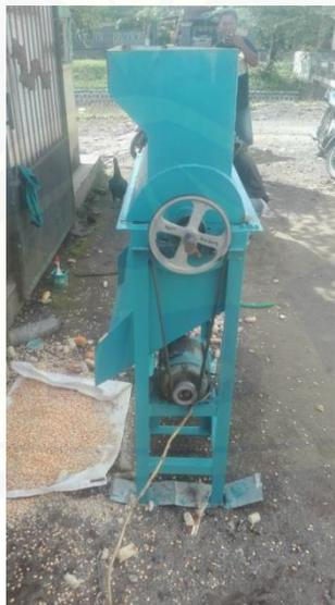
Gambar C.2 Mesin pemipil jagung tampak samping
