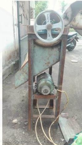
Gambar C.6 Pulley pada Poros pisau dan Motor
