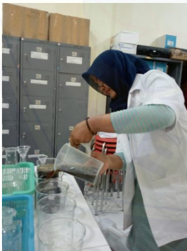
Gambar 3 Pemasukan air lindi ke beaker glass
