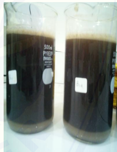
Gambar 8. Proses pembentukan flok oleh Tawas
