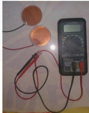
Gambar 3.6 Skema alat pengukur kapasitansi
