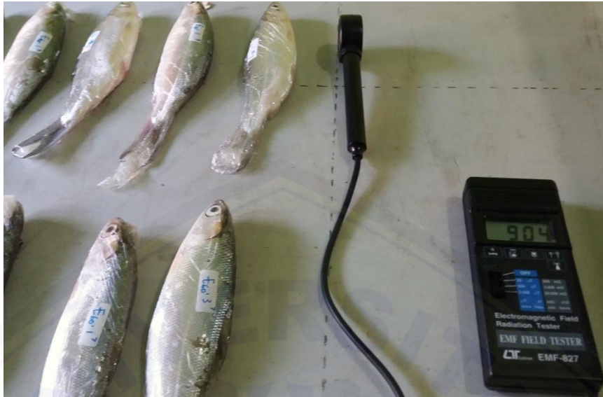
Gambar E. 3 Pengaturan Besar Intensitas Medan Magnet ELF Menggunakan Alat EMF Tester
