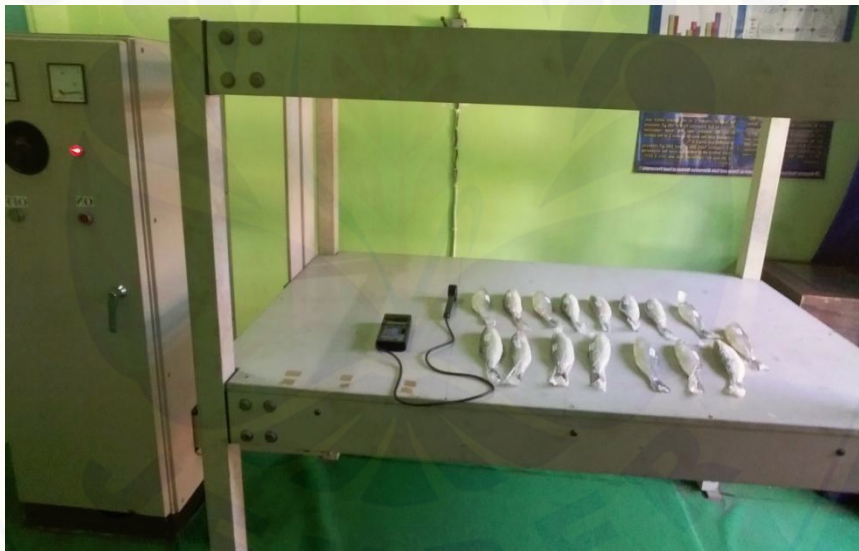
Gambar E. 2 Proses Pemaparan Sampel Ikan Bandeng Eksperimen Menggunakan Alat Penghasil Medan Magnet ELF
