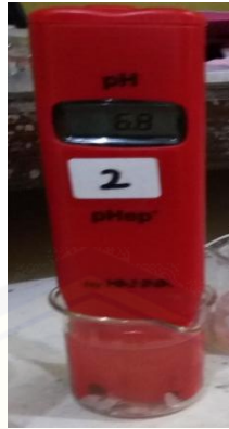
Gambar 3.5 Pengukuran pH menggunakan pH meter
