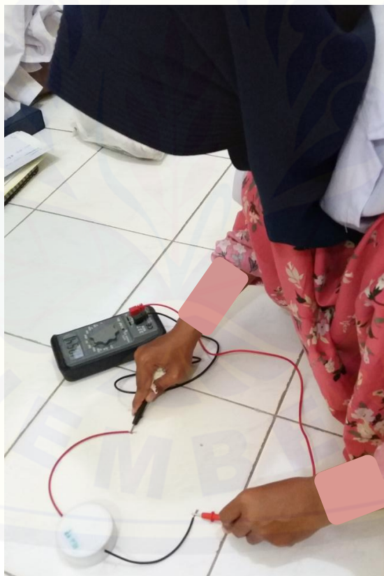
Gambar E. 10 Pengukuran nilai kapasitansi
