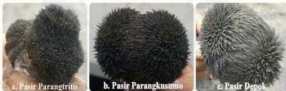
Gambar 2.6 Garis medan magnet yang terlihat pada pasir uji yang diekstrak menggunakan magnet permanen (Sumber: Lusiya, 2014)
