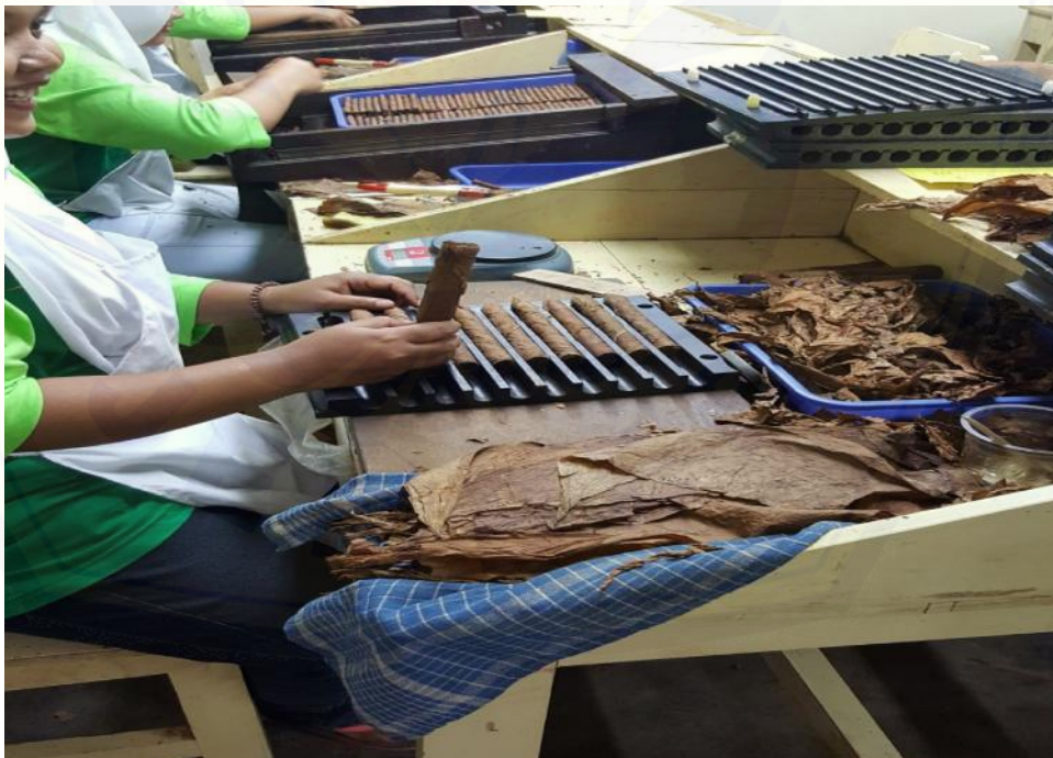
Gambar 8. Proses Produksi pada tahap Binding beserta alat produksi yang digunakan
