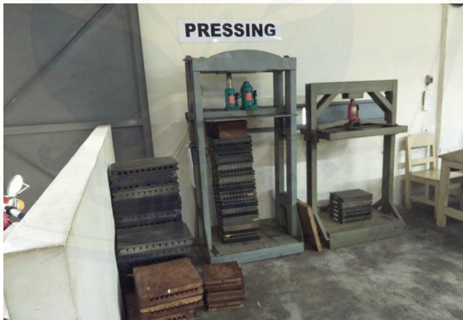
Gambar 10. Proses produksi pada tahap Pressing dan alat produksi yang digunakan
