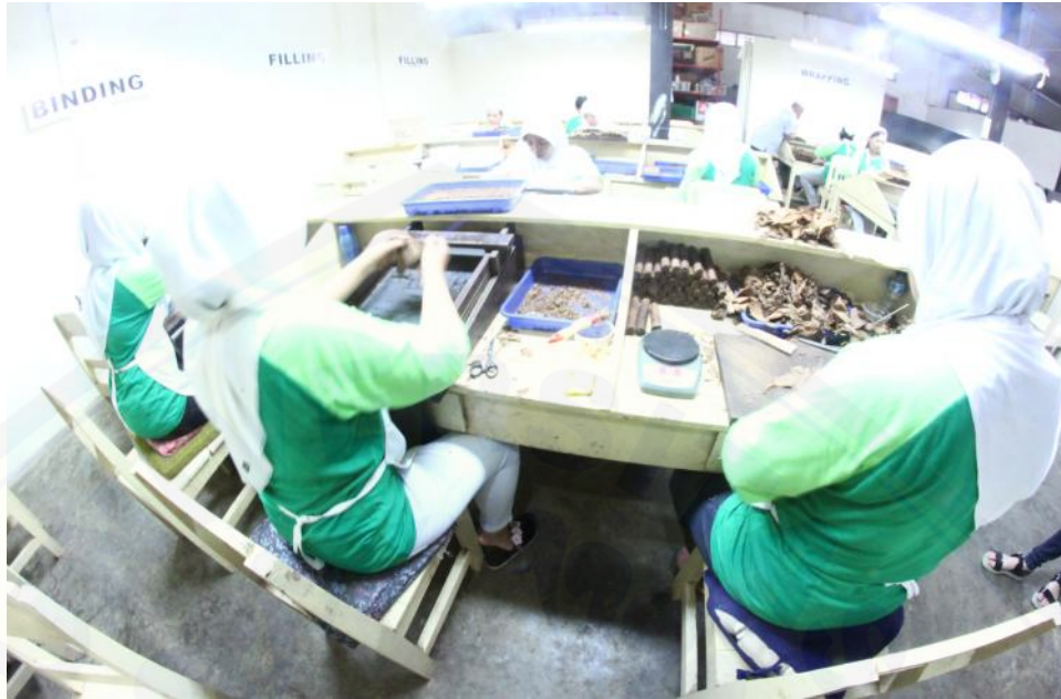
Gambar 7. Proses Produksi pada tahap Binding beserta alat produksi yang digunakan
