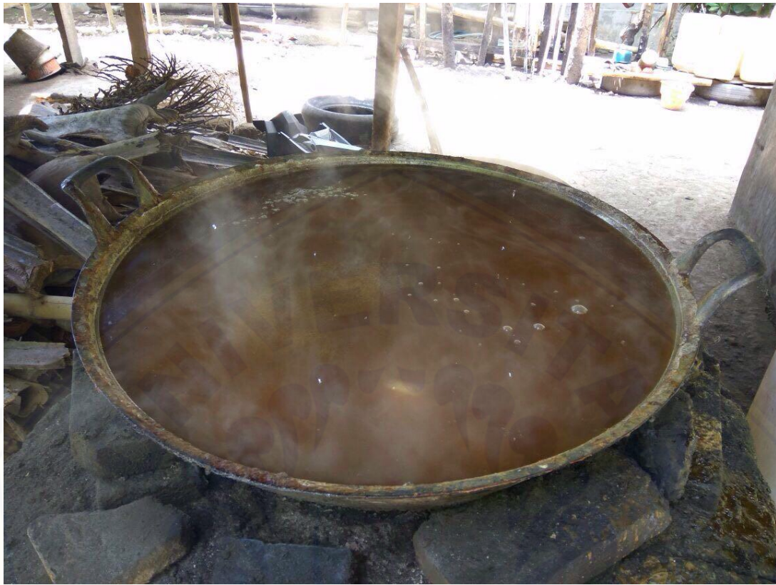
Gambar 1. Proses Pemasakan Nira Menjadi Gula Kelapa Non Sulfit
