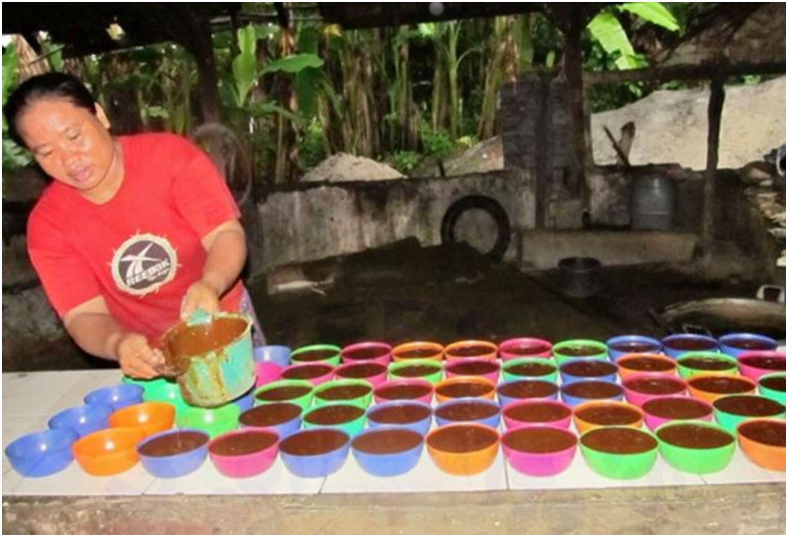
Gambar 3. Proses Pencetakan Gula Kelapa Non Sulfit
