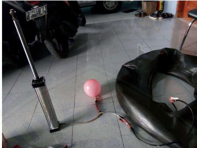
Gambar C.3 Pengisian biogas ke balon menggunakan Pneumatic hydrolic
