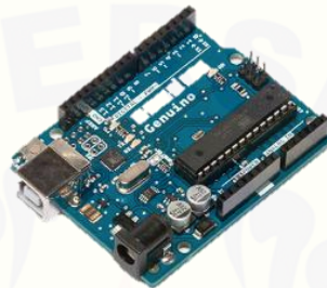
Gambar 2.16 Arduino UNO R3 (sumber: arduino.cc)
