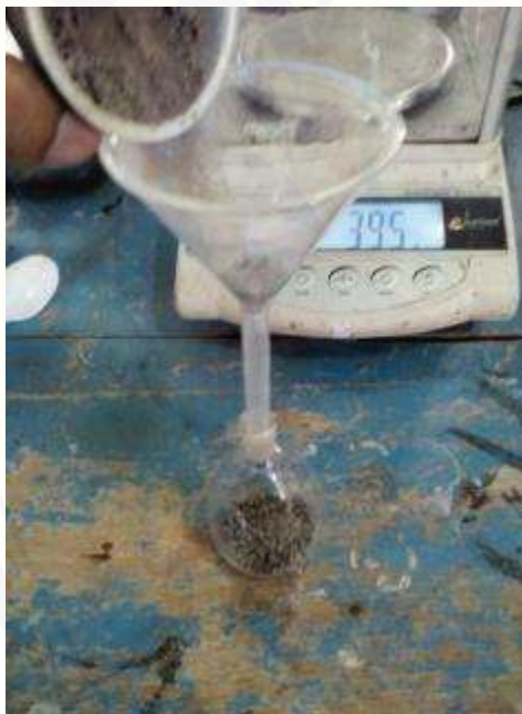
Memasukkan dan menimbang Sample Tanah (Tanah Asli dan Campuran) dalam Picnometer
