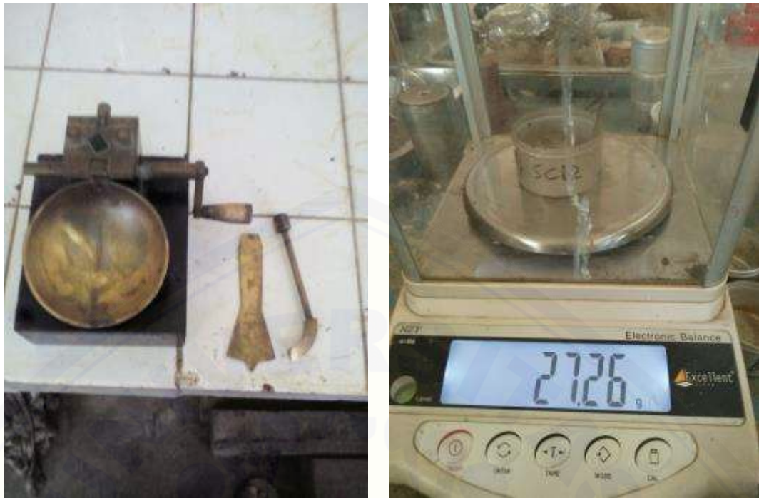
Alat cassagrande untuk pengujian atteberg limit
