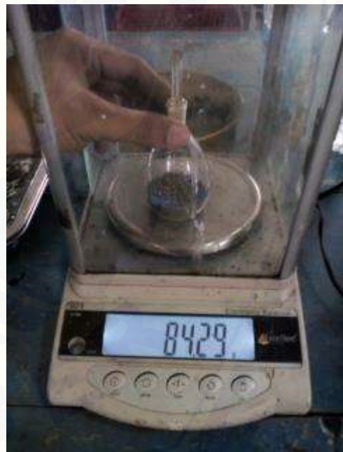
Memasukkan dan menimbang Sample Tanah (Tanah Asli dan Campuran) dalam Picnometer
