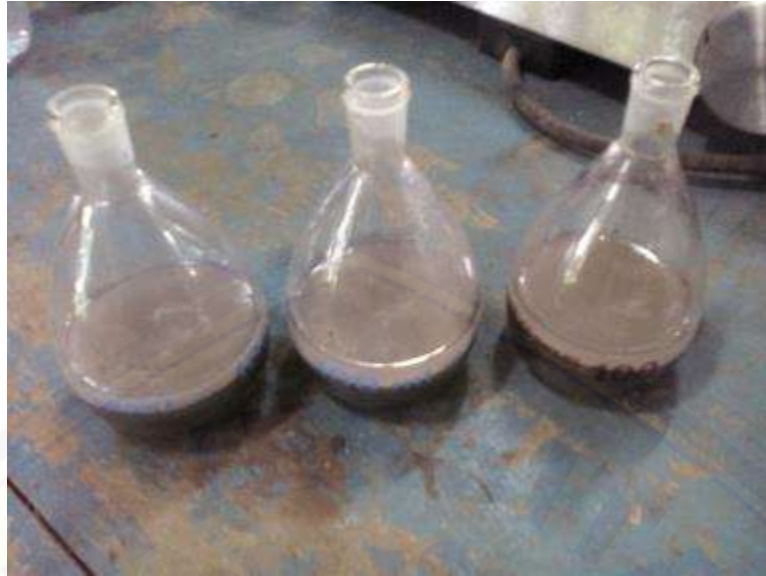
Sample Tanah diberi 2/3 air dari picnometer lalu dikocok hingga merata
