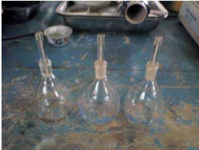
Picnometer Pengujian Berat Jenis
