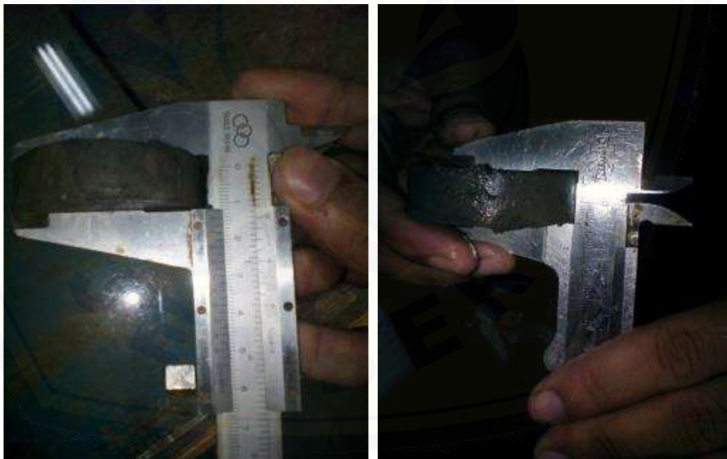
Pembacaan tinggi awal dan akhir deformasi benda uji
