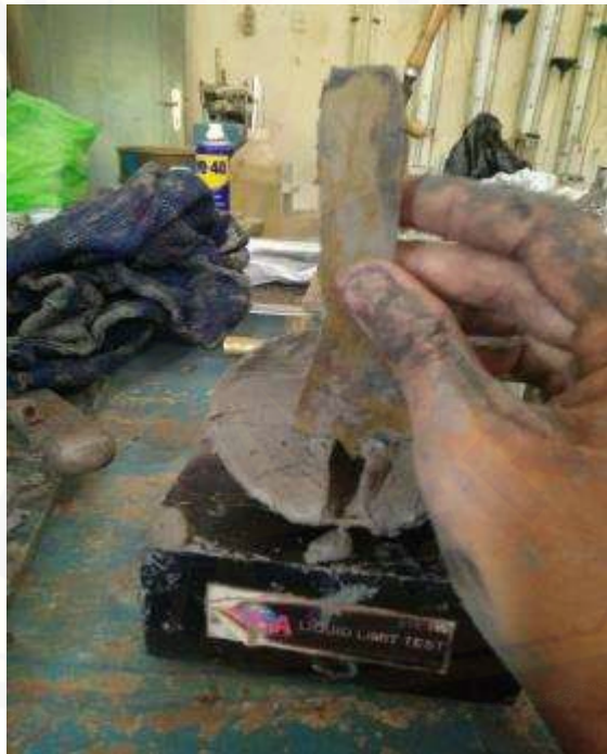
Mengetuk bebas jatuh dan mengukur sample tanah dengan
