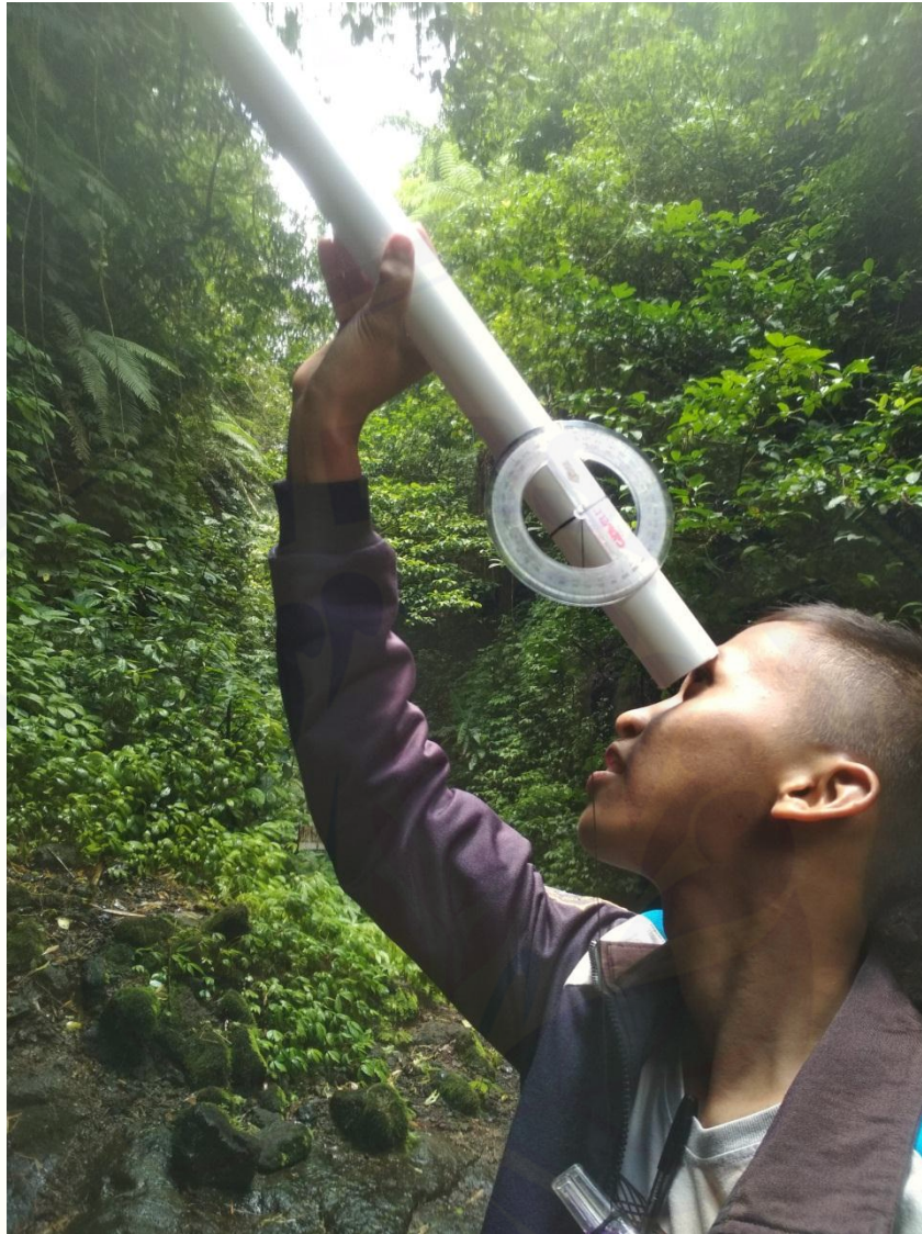
Gambar H4. Pengukuran ketinggian air terjun menggunakan pendekatan prinsip trigonometri
