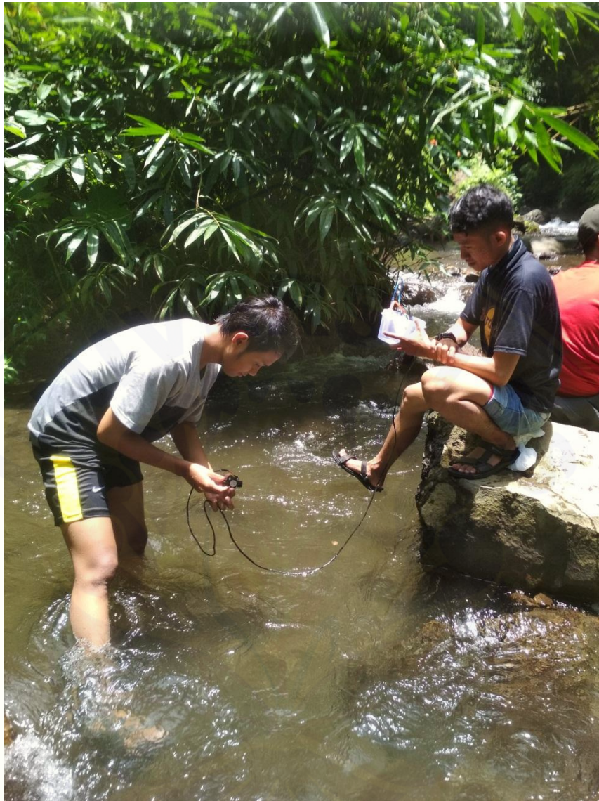
Gambar H3. Pengukuran debit menggunakan sensor Waterflow
