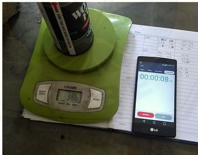
Lampiran H.2 Penimbangan uji konsumsi bahan bakar LPG
