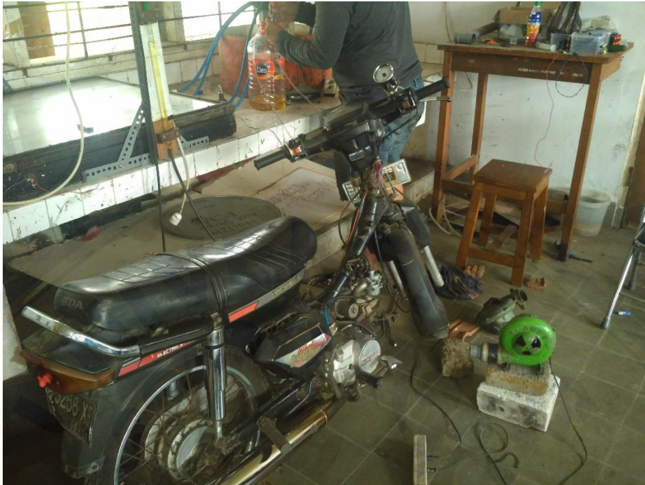
Lampiran H.1 Pengujian konsumsi bahan bakar Premium
