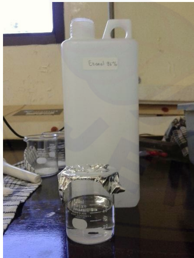
Disiapkan etanol 96% sebanyak 40mL untuk melarutkan asetosal dan etil selulosa
