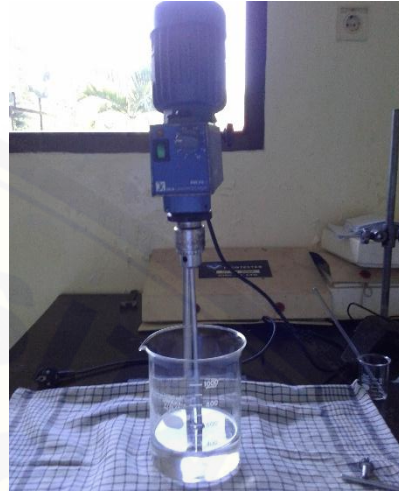
Dimasukkan campuran tween 80 dan paraffin liquid , serta diaduk dengan four blades propeller
