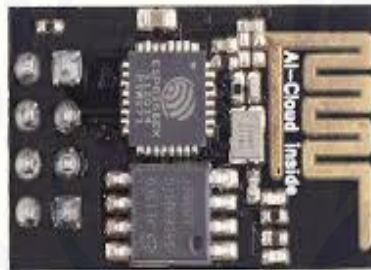
Gambar 2.6 Bentuk Fisik Modul Wifi ESP8266 (Sumber: Markus,2017)
