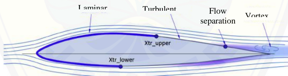
Gambar 2.2 Karakteristik Aliran Udara pada Airfoil (Gudmundsson, 2014)
