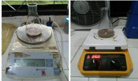
Gambar 3.7 Penimbangan abu ampas tebu dan pengadukan campuran abu ampas tebu dengan NaOH (Sumber : Koleksi Pribadi)
