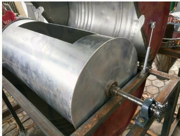
Gambar C.22 Proses Pemasangan Tabung Silinder
