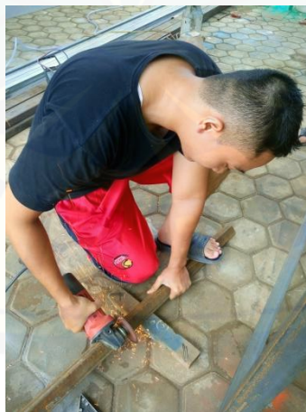
Gambar C.11 Proses Pemotongan Besi Profil L Sebagai Rangka
