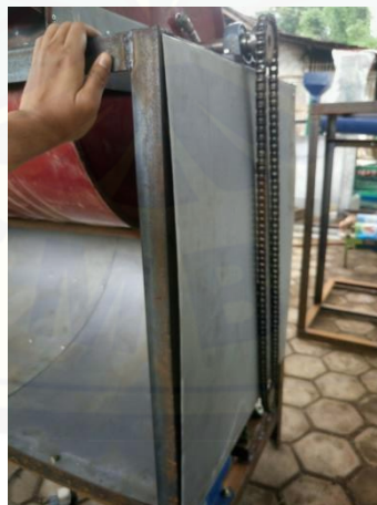
Gambar C.32 Proses Pemasangan Penutup Samping
