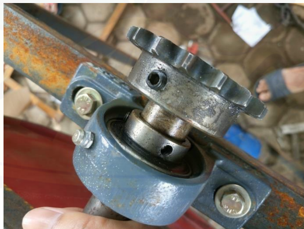
Gambar C.17 Proses Pemasangan Bearing dan Poros
