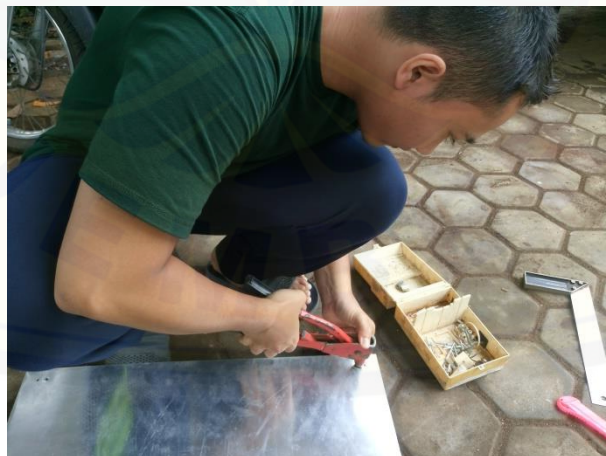
Gambar C.26 Proses Pemasangan Clamp Pengunci pada Tutup Tabung
