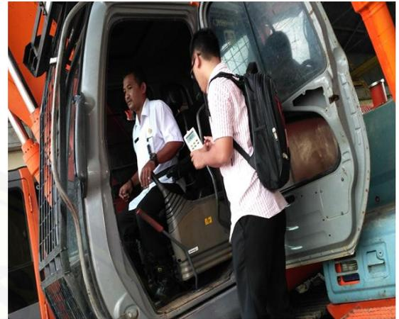
Pengukuran Getaran pada Operator Alat Berat Excavator Saat Alat Berat Dihidupkan
