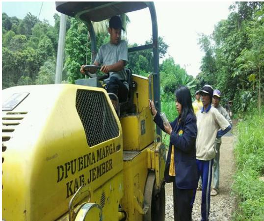
Pengukuran Getaran pada Operator Alat Berat Mesin Gilas Saat Alat Berat Dihidupkan
