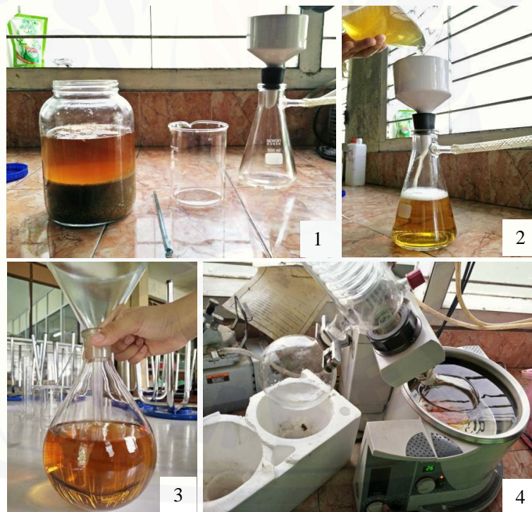
1) Perendaman bubuk akar Taraxacum officinale dalam etanol 70%; 2) Proses penyaringan menggunakan vacuum ; 3) Filtrat hasil penyaringan; 4) Proses penguapan etanol menggunakan rotary evaporator
