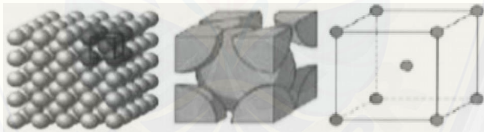
Gambar 2.4 Struktur Kristal Body Centered Cubic (BCC) (Sumber: Mangonon, 1999)
