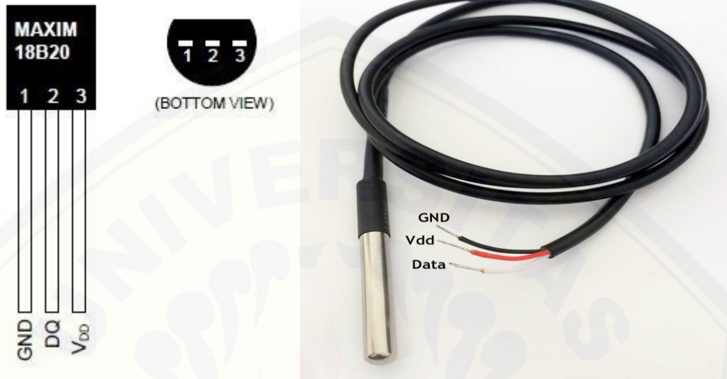
Gambar 2.8. Sensor Suhu DS18B20 (Datasheet DS18B20, http://www.digchip.com )
