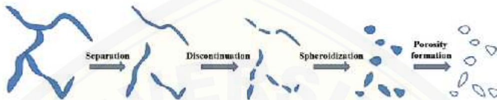
Gambar 2.7 Skematik evolusi mikro dan mekanisme pembubaran domain Mg selama perlakuan panas homogenisasi (Ashkan 2015).
