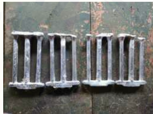
Spesimen yang sudah di cor
