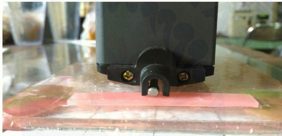
Proses Pengujian Kekasaran Permukaan menggunakan alat *Surface Roughness Tester TR 220*
