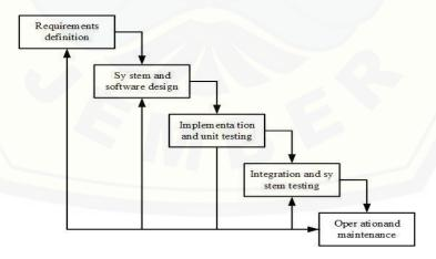
Gambar 3. 1 Tahapan pengembangan sistem model waterfall
