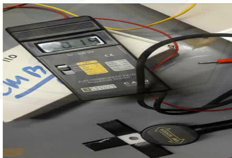
Nilai Kerapatan Magnet Neodymium Diukur Dengan Gauss Meter Sebesar 0,14 \mu\text{T}
