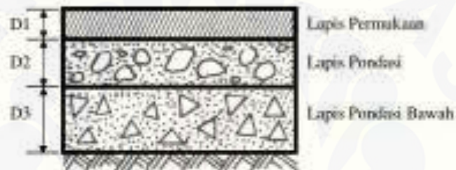
Gambar 2. 1 Susunan perkerasan jalan
