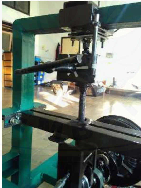
Gambar C.9 Penyetelan penekan beban radial
