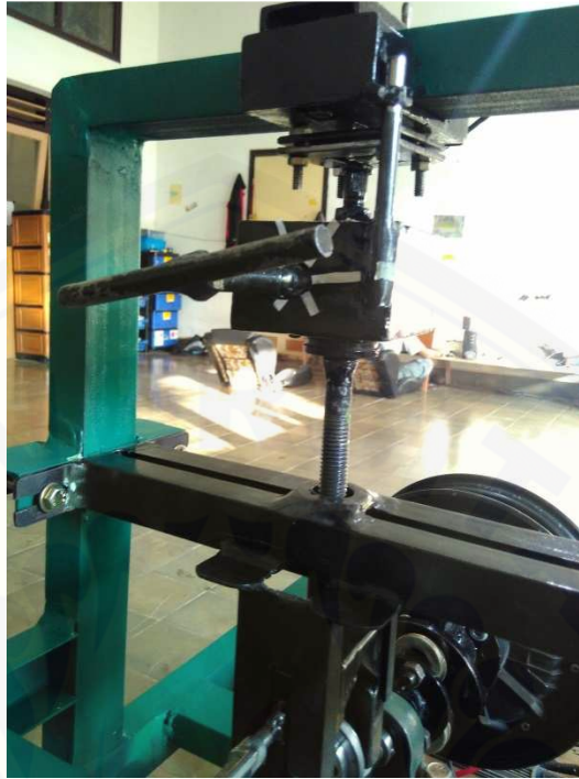
Gambar 3.10 Mekanisme pengatur beban radial bantalan
