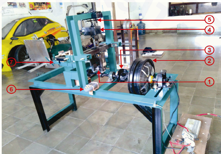
Gambar 3.1 Alat uji rolling resistance pada bantalan
