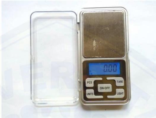
Gambar 3.2 Timbangan Emas Load Cell 200 gram
