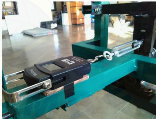
Gambar 3.11 Mekanisme pengatur beban aksial bantalan
