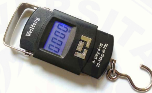
Gambar 3.4 Timbangan gantung load cell 50 kg
