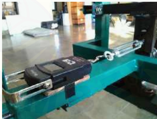
Gambar Mekanisme pengatur beban aksial bantalan
