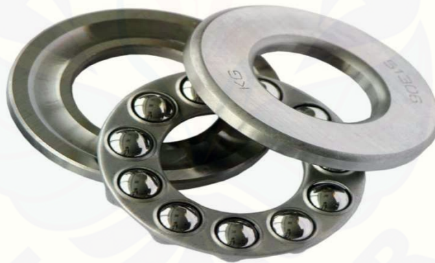
Gambar 2.3 Trust ball bearing , jenis bearing yang digunakan menumpu beban aksial. (sumber : kginternational.com/bearings/17/4/2017 )
