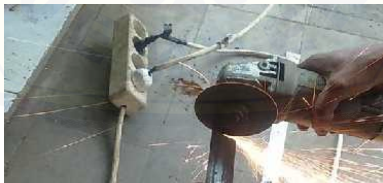
Gambar C.3 Pemotongan bahan (ST-37)
