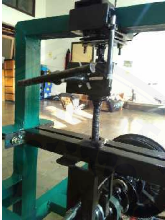
Gambar Mekanisme pengatur beban radial bantalan
