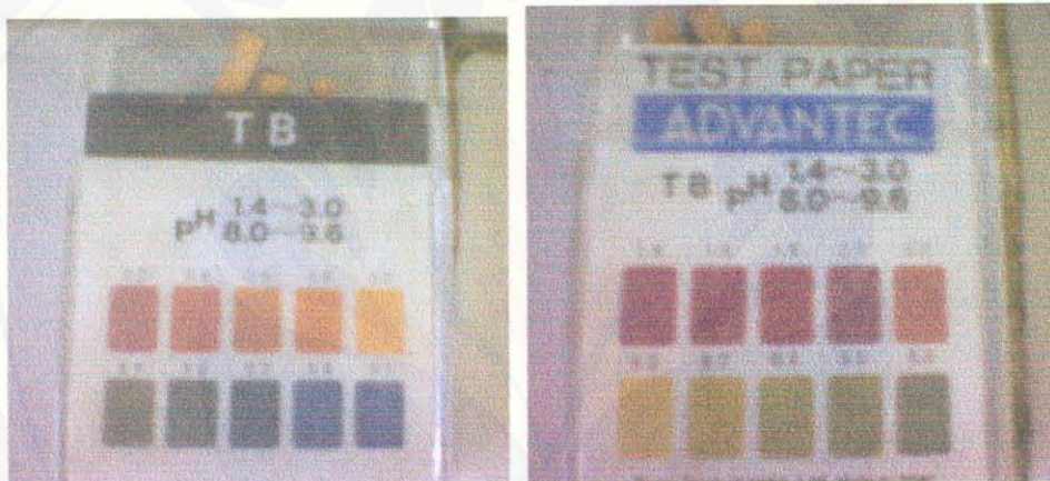
Gambar 3.1 Indikator Timol Blue dengan rentang pH 1,4~3,0 dan 8,0~9,6
