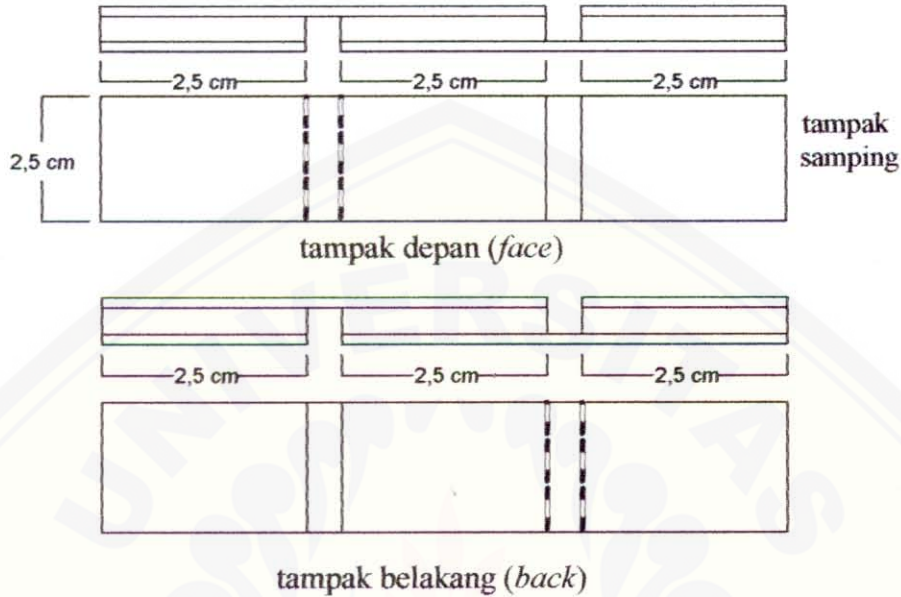
Gambar 3.3 Ukuran kayu yang akan diukur kuat tariknya tampak depan dan tampak belakang
