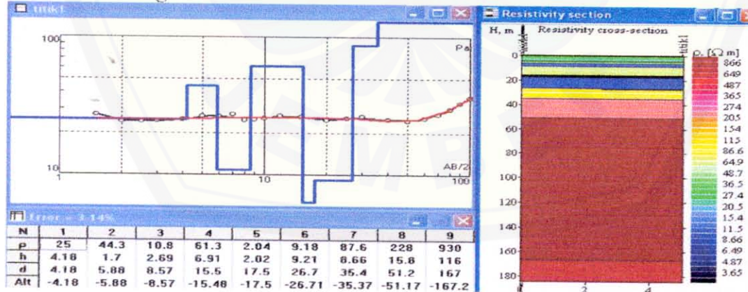
Gambar 4.3 Penampang Vertikal Dari Hasil Pengolahan Data Pada Titik Sounding 2
