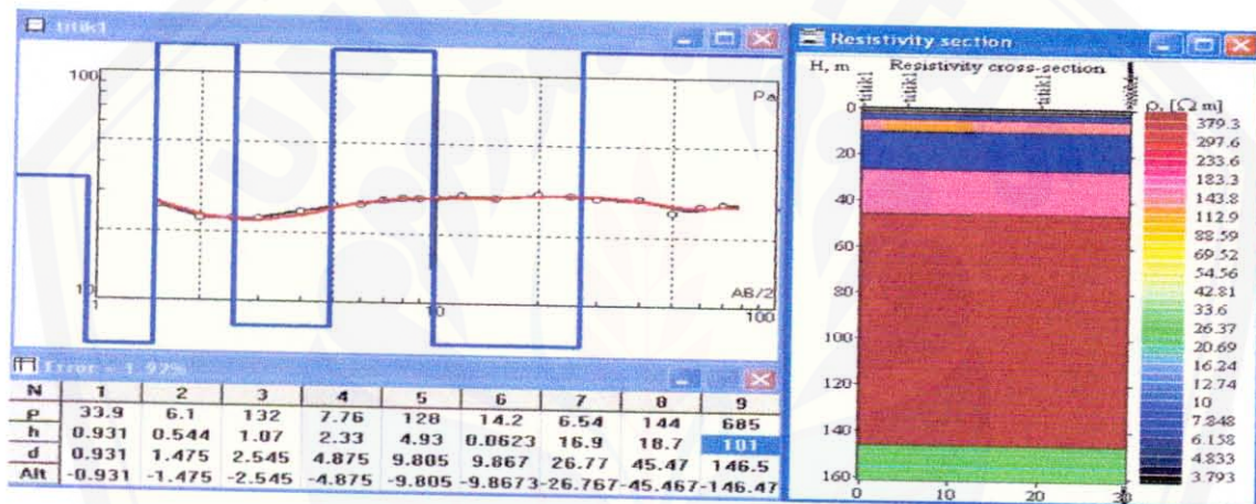
Gambar 4.2 Penampang Vertikal Dari Hasil Pengolahan Data Pada Titik Sounding 1
