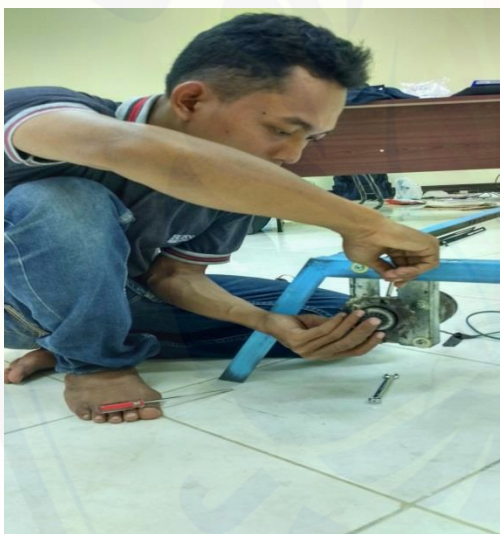
Gambar Pemasangan Gear pada Motor
