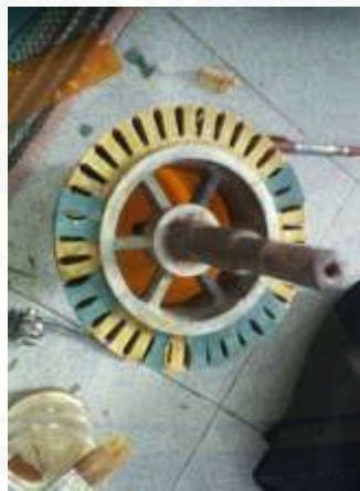
Gambar 5. Proses Penambahan Isolator dengan menggunakan kertas Pripsan
