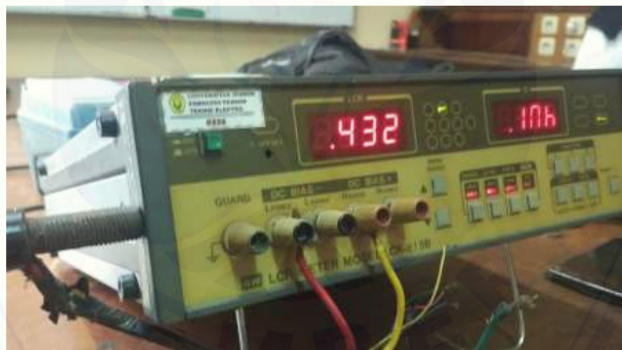
Gambar 2. Pengujian Induktansi Motor BLDC
