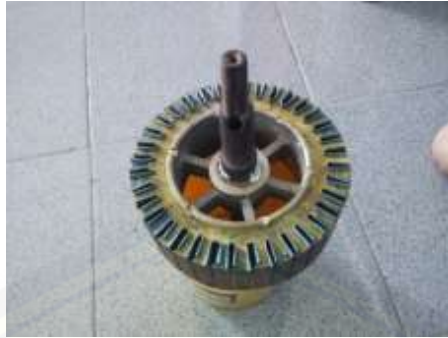
Gambar 6. Hasil Pemasangan Isolator pada Motor BLDC
