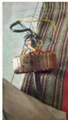
Gambar 4. Proses Peleburan Varnish pada Motor BLDC
