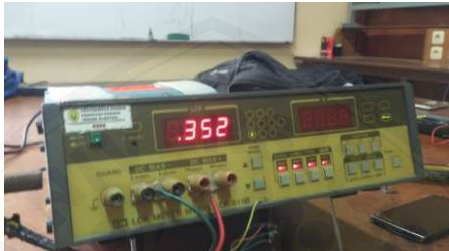
Gambar 1. Pengujian resistansi motor BLDC
