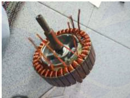
Gambar 8. Hasil Penggulungan diameter lilitan 0.45mm
