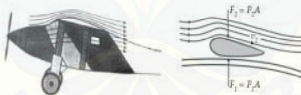
Gambar 2.10 Pemanfaatan hukum Bernoulli untuk desain sayap pesawat terbang
