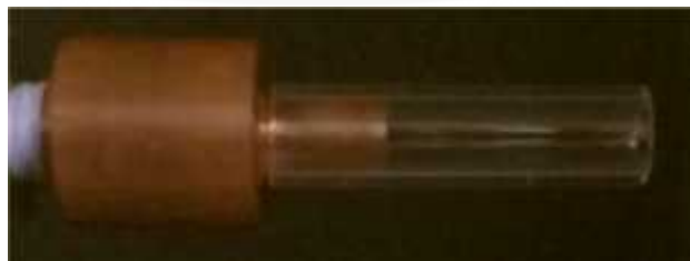
Gambar 3.1 Micro-scale combustor dengan sudden expansion
