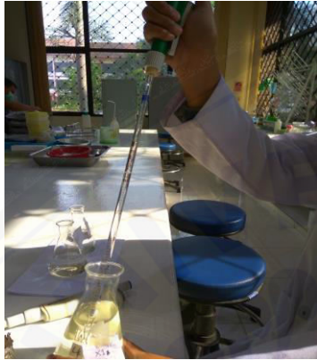
Gambar 13 Pengambilan Sampel Air Payau 100 ml
