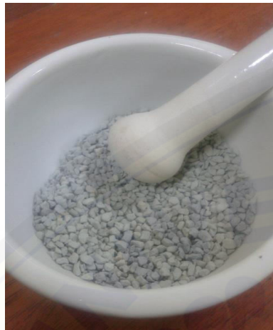
Gambar 1 Penumbukan Zeolit menjadi Ukuran yang Lebih Kecil
