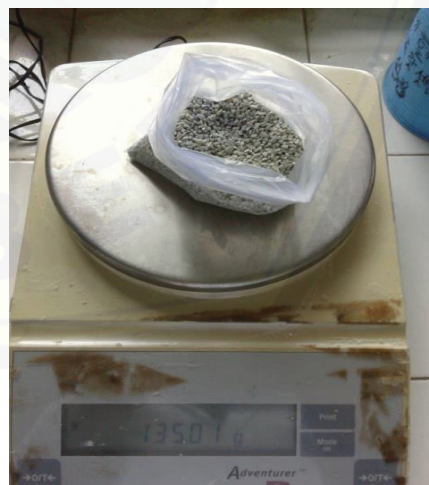
Gambar 12 Penimbangan Zeolit Sebanyak 135 gram
