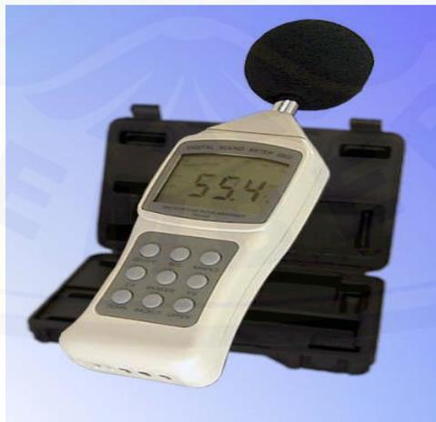
Gambar 3.2 Peralatan *Sound Level Meter*
