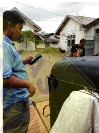
Pengujian getaran dengan beban padi
