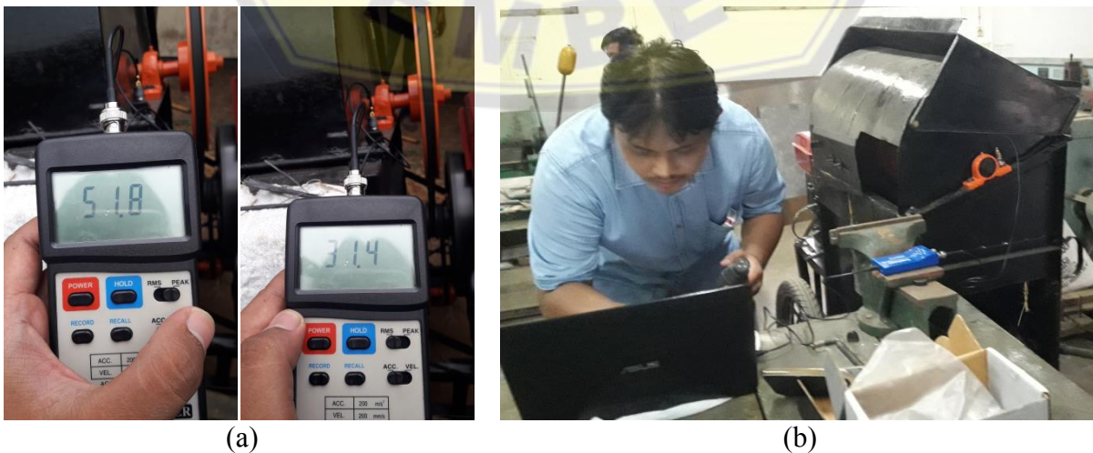
Gambar 5.2. (a) Pengujian vibrasi dengan vibrometer; (b) Pengujian rpm dan vibrasi dengan osiloskop
